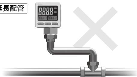
元配管から製品が離れると、延長配管部分の温度変化等の外乱によって正確な計測ができなくなります。また、元配管から遠くなることにより温度の伝達が遅れ応答が遅くなります。
