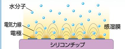
空気中の水分子を吸収する感湿膜が、水分子を取り込むことで変化する誘電率より、相対湿度を測定。
