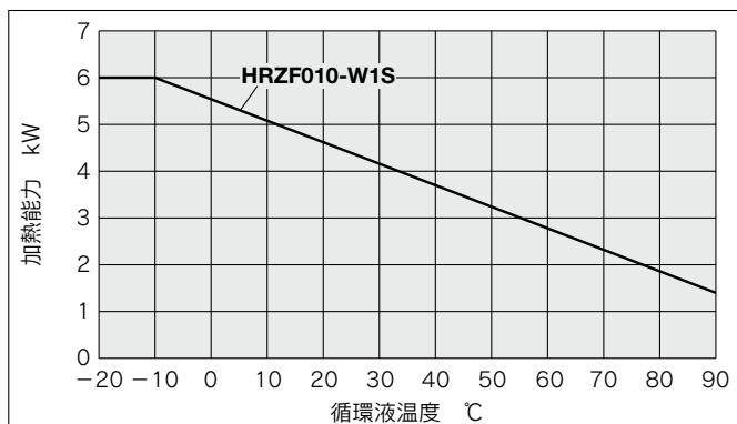
※ポンプインバータ周波数が60Hz(最大)で運転している場合。
