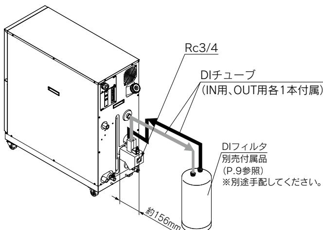
※DIフィルタはサーモチラーの外に設置して、配管で接続します。サーモチラーの背面にDIフィルタを設置するスペースを確保してください。
